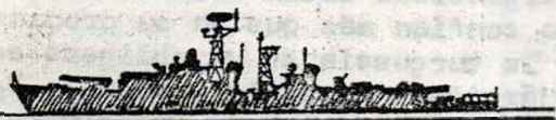
Destructor ruso lanza misiles de la serie Kroupnié 1962-63. 3500 toneladas. 150 metros. velocidad 38 nudos. Misiles tierra-aire. 20 cañones anti-aereos. 2 lanza torpedos (triple):
